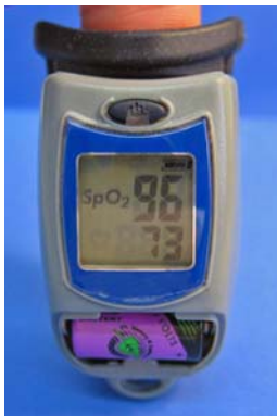
Blutsauerstoffmessgerät mit Lithium-Thionylchlorid(LTC)-Batterie
