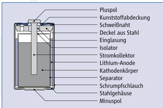
Abb. 1: Schnittzeichnung einer Zelle der Baugröße  $\frac{1}{2}\text{AA}$
