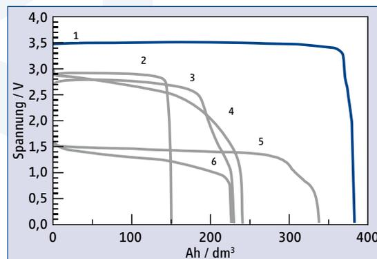
Abb. 2: Vergleich verschiedener Batteriesysteme. Die Kurven stellen die typischen Bestwerte handelsüblicher Rundzellen dar. Entladebedingung  $25^{\circ}\text{C}$  bei 1000-stündigem Strom. Die Fläche unter den Kurven entspricht der in der Liste unten angegebenen Energiedichte.
