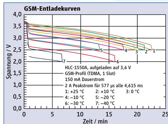
Abb. 2: GSM-Entladekurven
