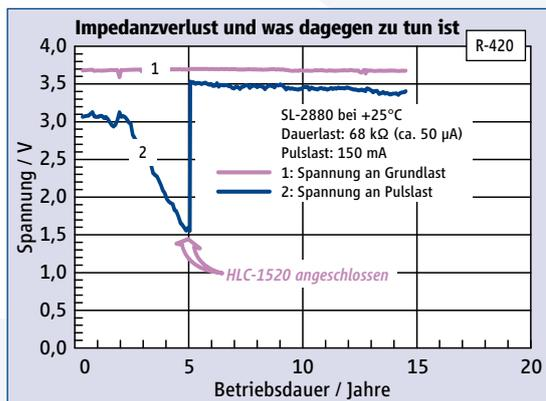
Abb. 1: Impedanzverlust und was dagegen zu tun ist
