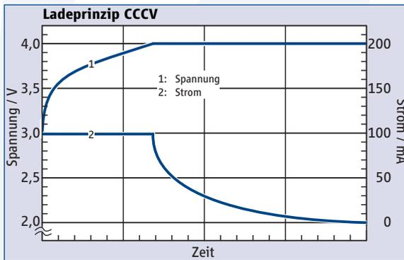
**Abb. 1: Ladeprinzip CCCV am Beispiel der TLI-1550A**
