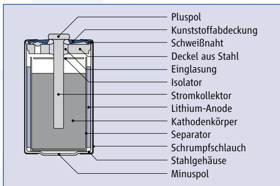
Abb. 1: Schnittzeichnung einer Zelle der Baugröße 1/2AA
