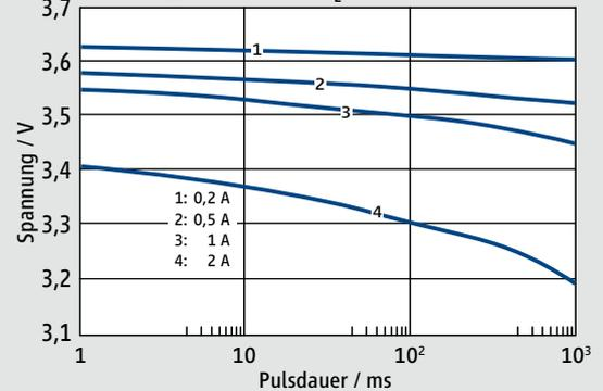
Spannung bei Li/SOCl<sub>2</sub>-Potential (3,67 V), 200 mA
