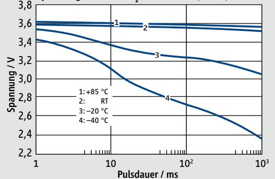
Spannung bei RT, Li/SOCl<sub>2</sub>-Potential (3,90 V)
