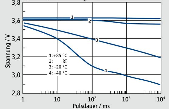
Spannung bei Li/SOCl<sub>2</sub>-Potential (3,67 V), 100 mA
