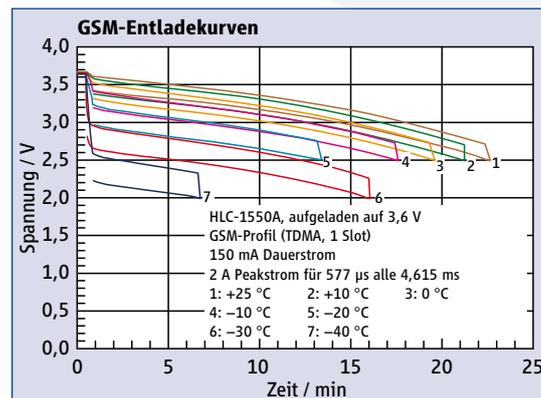
Abb. 2: GSM-Entladekurven
