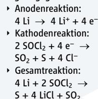
Das meiste Schwefeldioxid löst sich im Elektrolyten. Dadurch kann sich kein Überdruck in der Batterie aufbauen.
