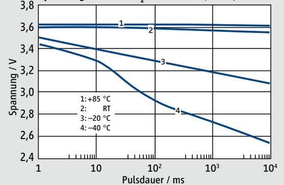
Spannung bei Li/SOCl<sub>2</sub>-Potential (3,90 V), 60 mA
