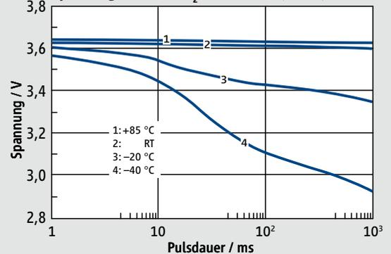
Spannung bei Li/SOCl<sub>2</sub>-Potential (3,67 V), 500 mA
