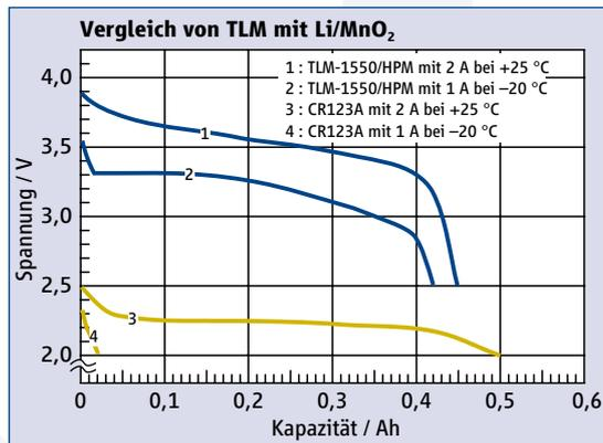
Abb. 1: Vergleich von TLM mit Li/MnO<sub>2</sub>
